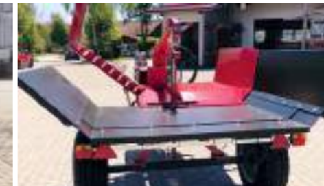
Flaches Wannenblech zum Zurückziehen der Stämme
