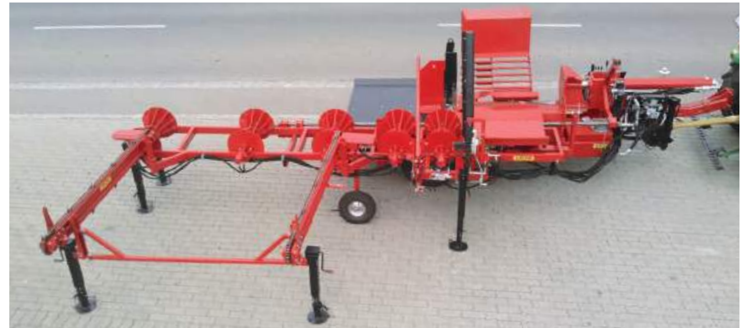
GSW 40 F-ZW mit Sägeaggregat und Querförderer
