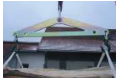
Hebetraverse für Meterbündel
