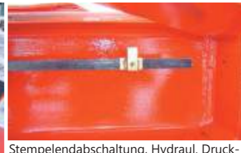
Stempelendabschaltung, Hydraul. Druckspitzen werden unmöglich. Das schont die Hydraulikpumpe
