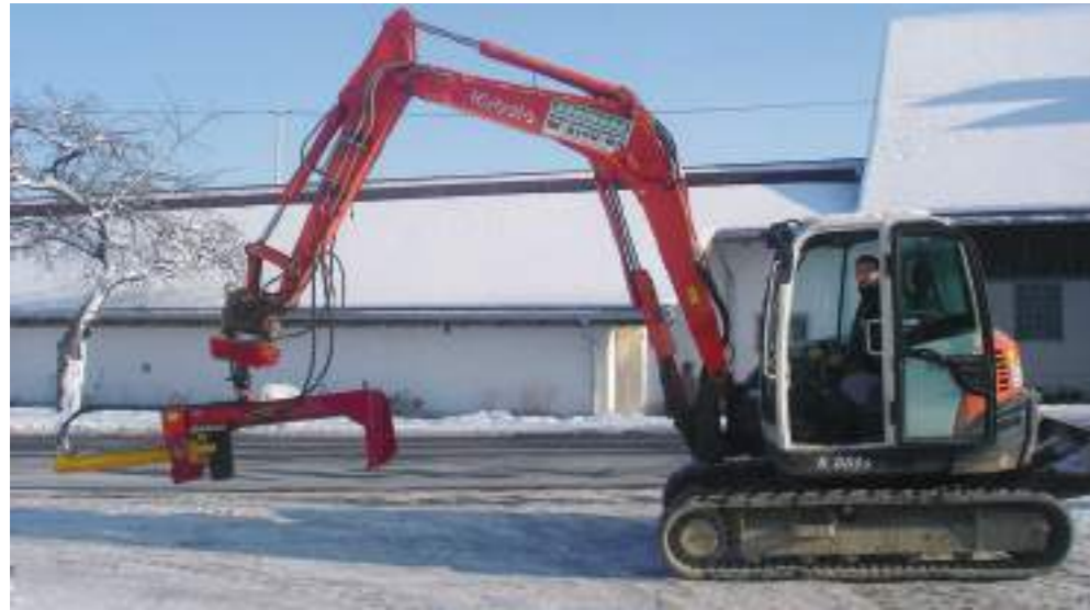
Der GROWI-Baggerspalter kann an jeden Bagger ohne Dreipunkt-Traktorkran angebaut bzw. angepasst werden.
