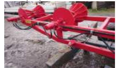
Hydraulischer Ölmotor ohne Kette
