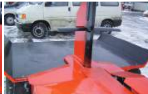
Spaltkreuz, Spalttisch und der patentierte Übergang sichtbar
