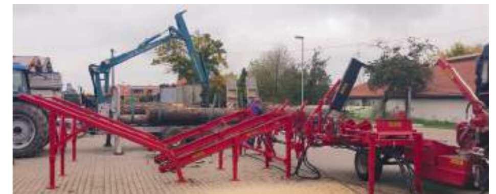
GROWI Sägeeinheit mit GSW 40 F und Querförderer
