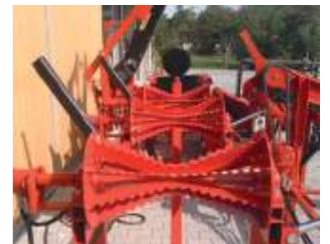
Übergang Querförderer zur Sägeeinheit
