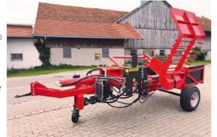
Schichtholzspalter auf Fahrwerk
