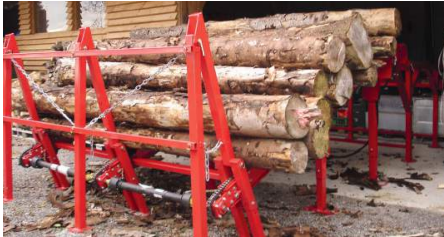
GROWI Querförderer für echtes Brennholz. Stabiler Querförderer, Fassungsvermögen eines ganzen Rückewagens.
