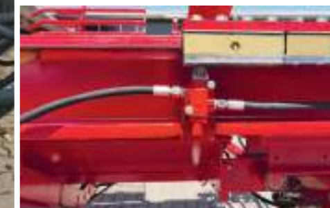
Höhenverstellbarer Spaltkanal zum Einstellen der Scheitholzgrößen
