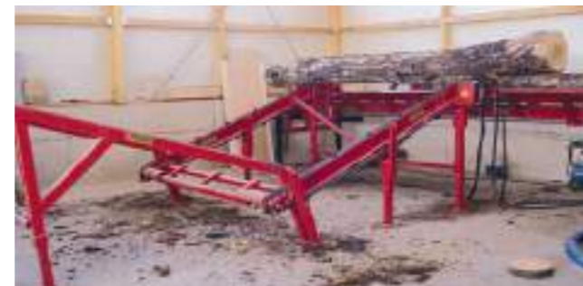
Ablängeinheit mit Querförderer
