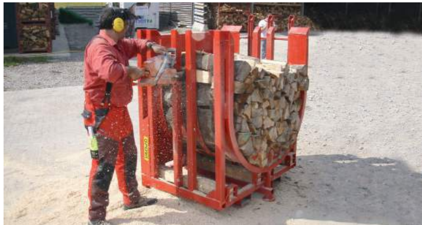
Einen Raummeter Brennholz im Bündel sägen, ein Schnitt in einer Minute
