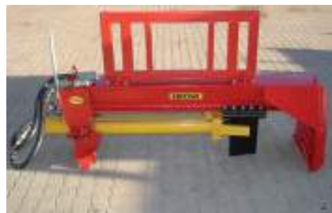
Baggerspalter mit Euroaufnahme für Frontlader in Transportstellung
