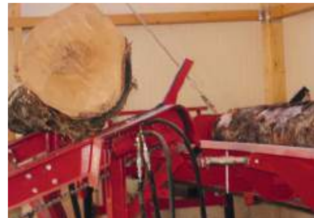
Mechanische Vereinzelung mit 2 robusten hyd. Antriebe
