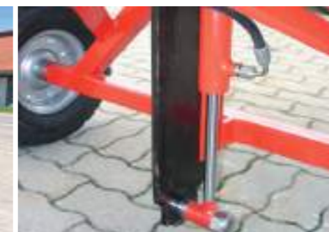
Hydraulisch verstellbares Spaltkreuz
