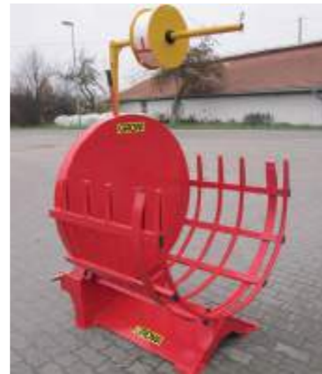
Bündelgerät mit Galgen als Rollenhalter und Box für Klammern und Bandspanner
