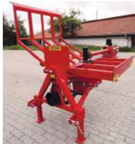
Dreipunkt-Aufnahme für Schlepper
