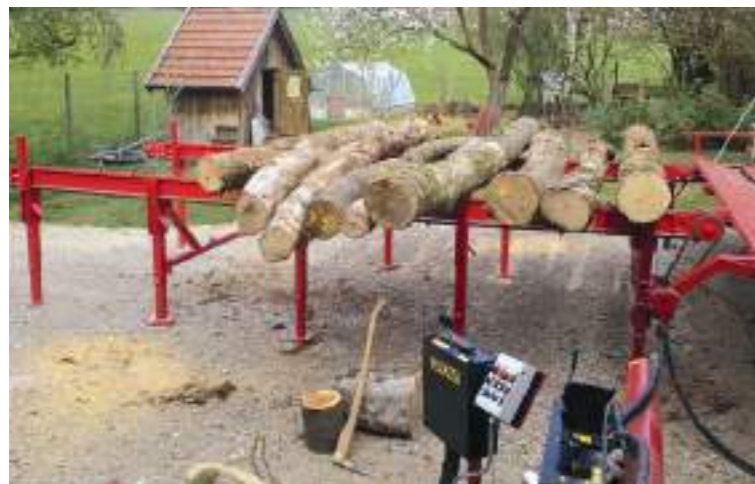
Querförderer gerade 6 m lang mit zwei Zügen, besser bei Starkholz ab 60 cm Durchmesser
