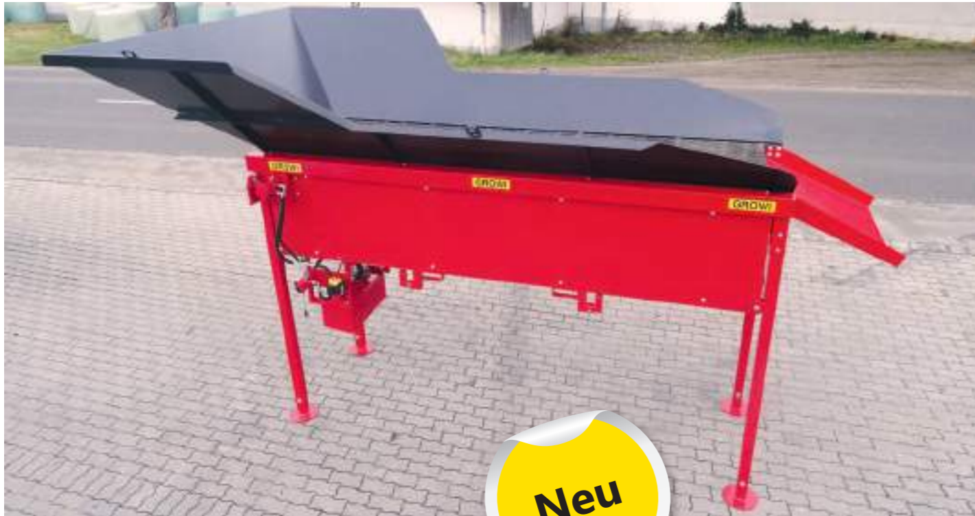
GRS 3100 Scheibenreiniger mit großem Einlauftrichter
