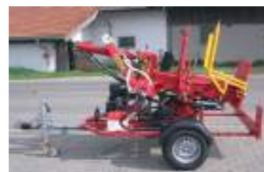
GN 18, GS 20, GS 25 mit 80 km/h Fahrwerk und Benzinmotor
