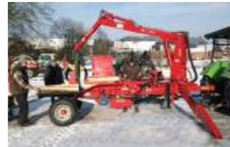
GROWIAN II GSW 30 F-ZW mit 6,70 m Kran und 1.000 kg Hubkraft
