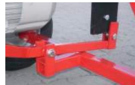
Mechanische Spaltkreuzverstellung Auf Wunsch: hydraul. Kreuzverstellung
