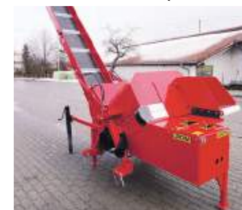
Hochleistungssäge mit Dreipunktaufnahme
