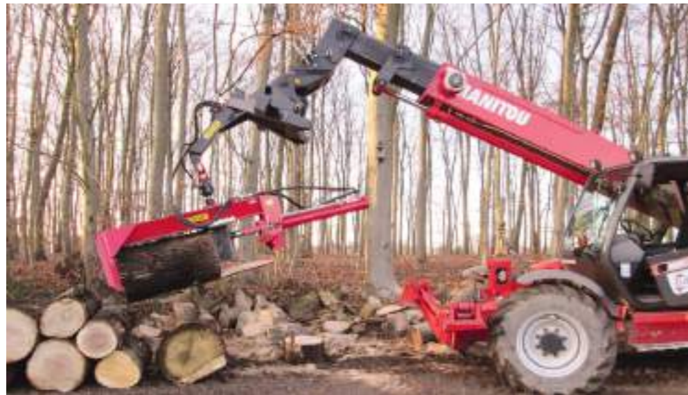
Der GROWI-Baggerspalter am Manitou-Teleskoplader mit Galgen und drittem elektrischen Steuerkreis am Spalter
