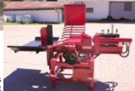
GSW 14 K/D als Dreipunktgerät
