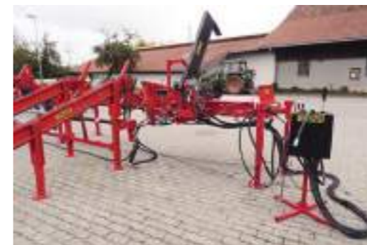
GROWI Sägeeinheit mit Bedienpult
