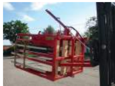
Sägekorb für Stapler mit hydraulischem Auskippemechanismus
