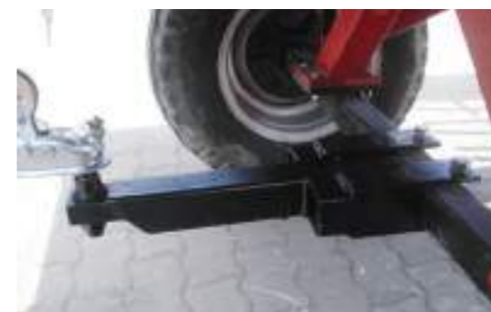
Kugelkopfkupplung wie am PKW, TÜV-Abnahme
