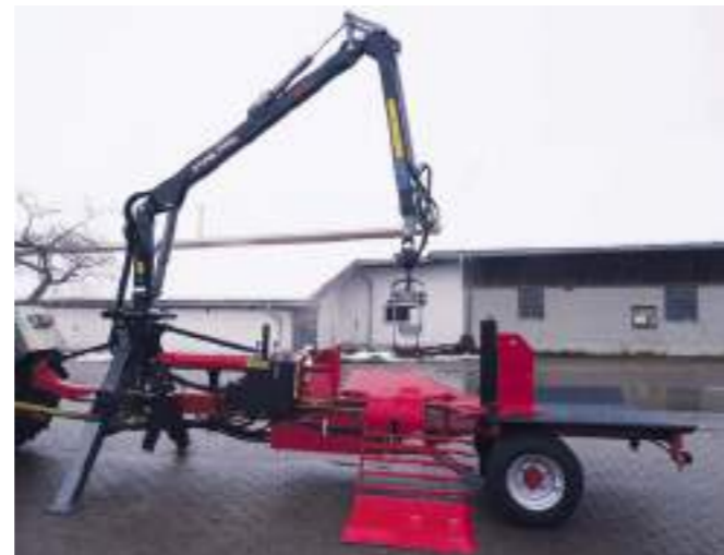
Kran mit Untenbedienung
