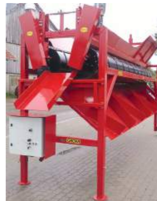
2 Getriebemotoren mit frequenzgesteuerter Drehzahl
