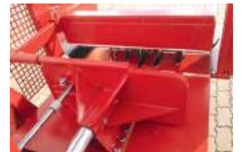
Große Druckplatte mit Rückholzieher und 6-fach Schichtspaltmesser
