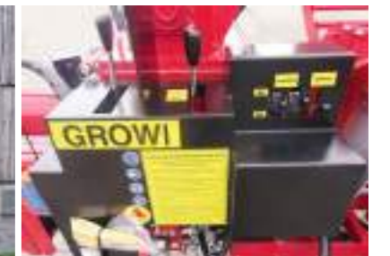
Kombinierte Bedienung, Hand- und Elektrosteuerung
