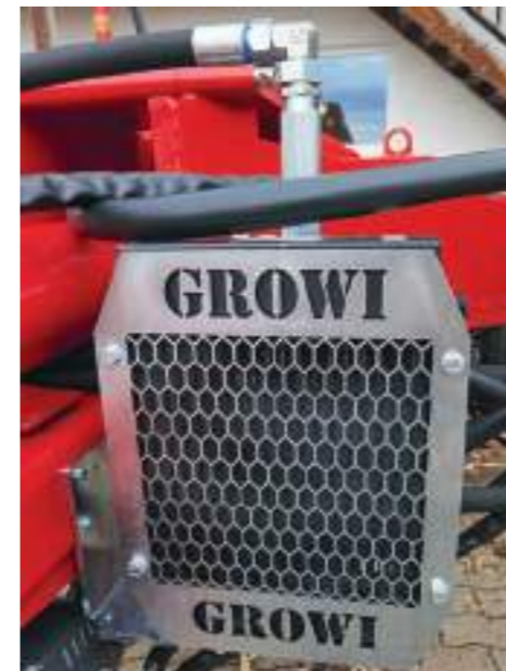
Großer Ölkühler mit hydraulischem Lüfterantrieb
