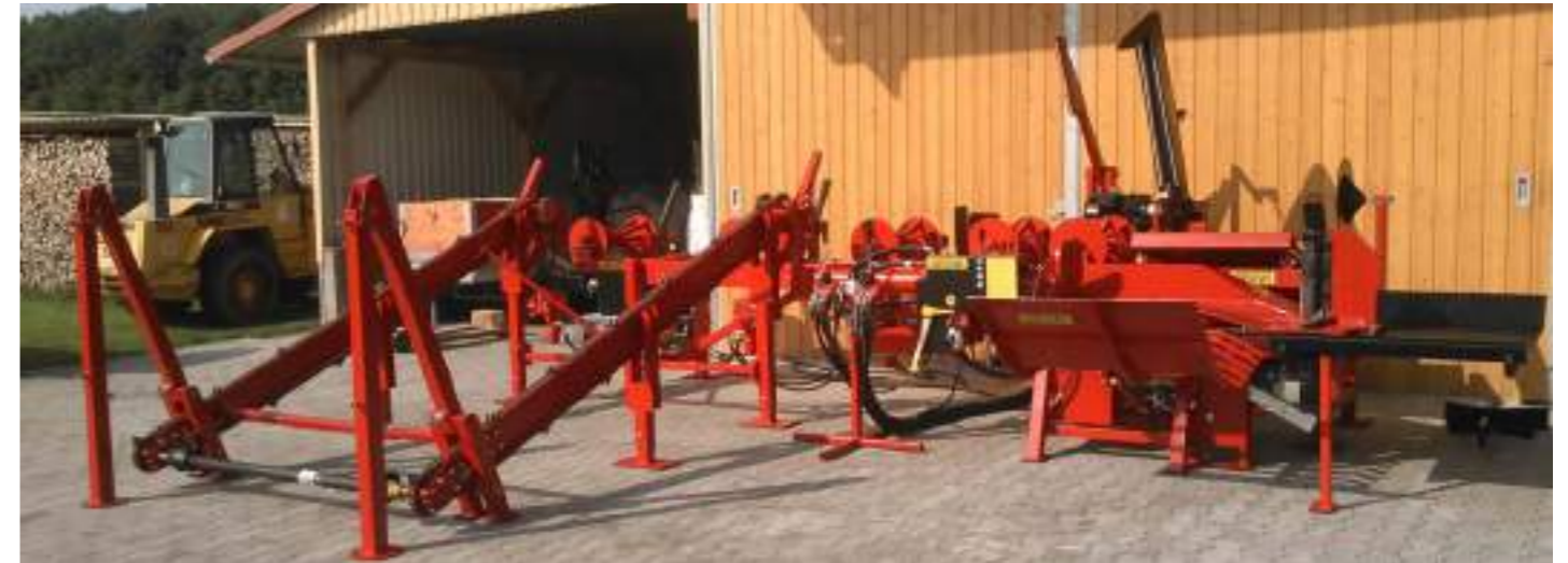
GROWI Sägeeinheit zum Ablängen von Meterholz
