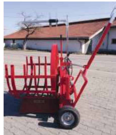
Bündelgerät mit Euro- und Dreipunktaufnahme auch zum Nachrüsten
