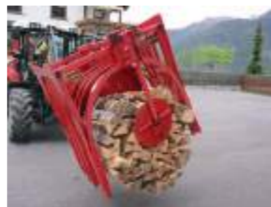
Drehbarer Sägekorb zur Aufnahme der Bündel ohne Absteigen
