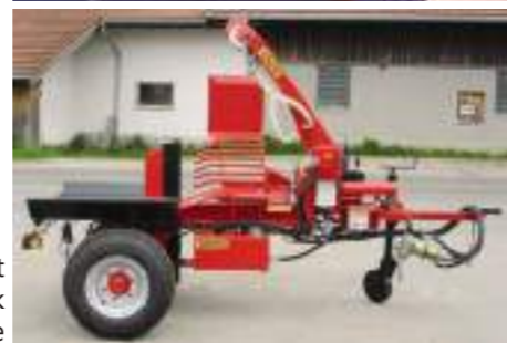
GSW 14 K/F mit großem Fahrwerk und Seilwinde
