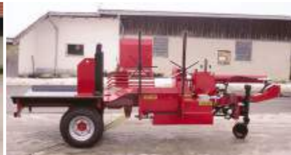
GSW 40 F-ZW-Turbo mit 6-fach u. 8-fach Spaltkreuz
