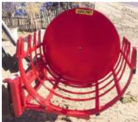
Bündelgerät mit Euroaufnahme ohne Drehmechanismus
