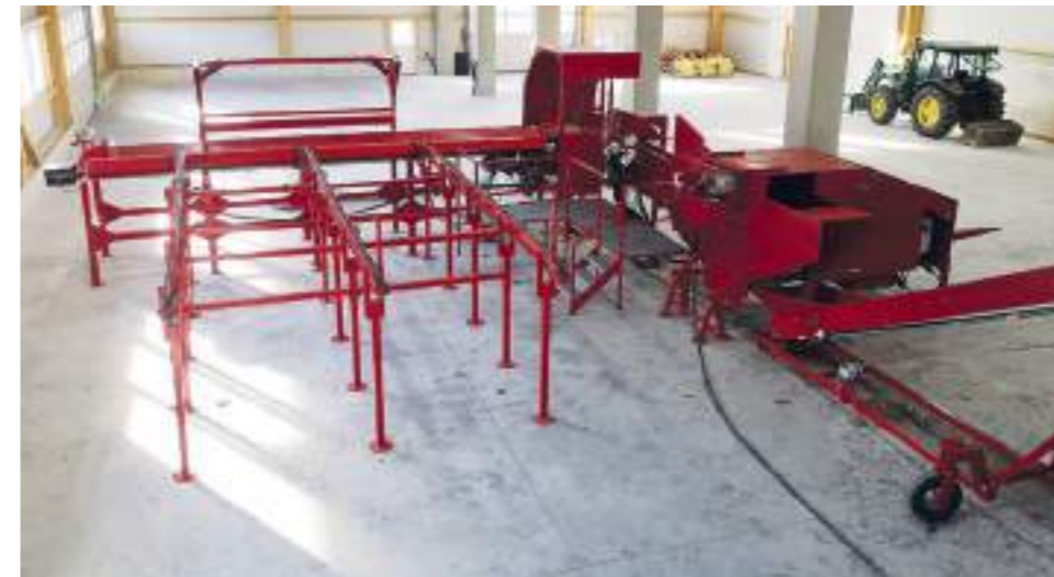
Softübergabe vom Querförderer in den Stammkanal
