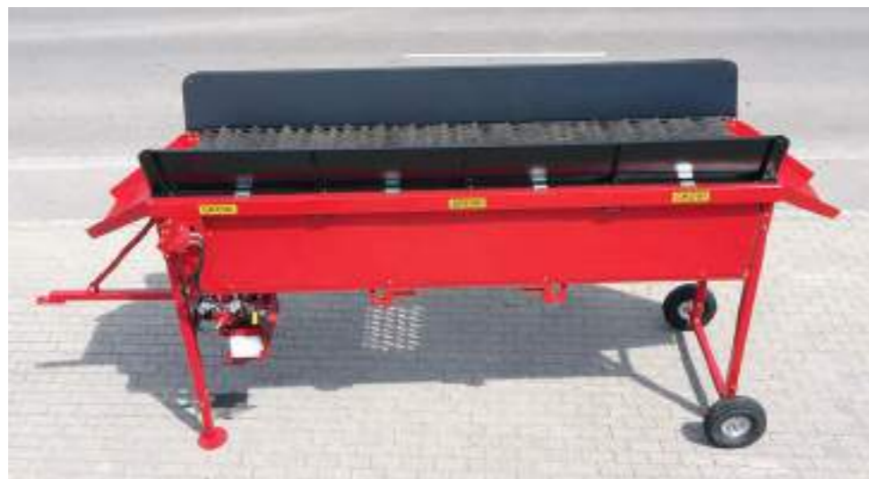
Scheibenreiniger mit zwei Auslauftrichter
