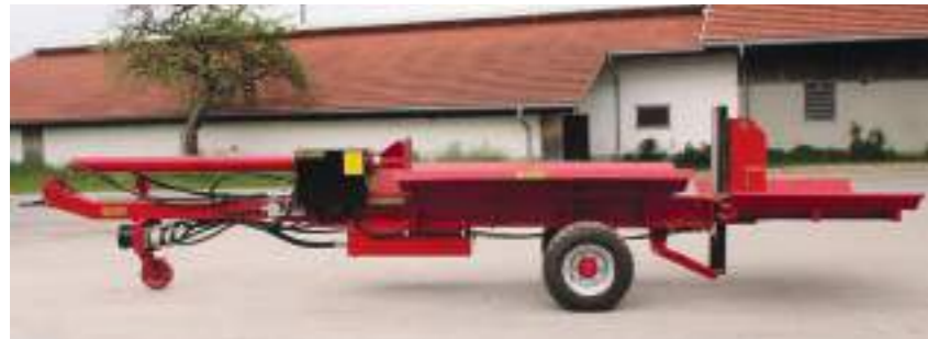
GSW 40 F - 2700 , lange Version mit 2,70 m Spaltlänge
