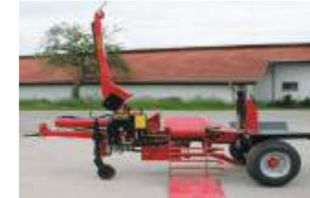
Zur Kranbeschickung weggeschwenkt
