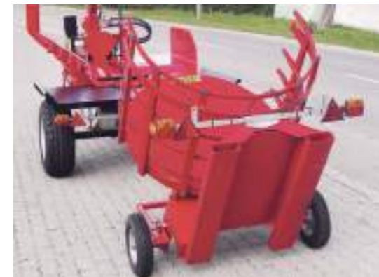
Fahrwerk mit Beleuchtung und Straßenzulassung
