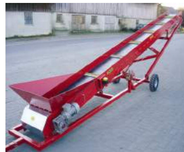
Elektr. ZW-Antrieb mit 7,5, 9,2, 11, 15, 18,5 o. 22 KW Antriebsleistung mit Fahrwerk
