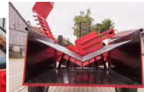
Spezial Schichtholzspaltmesser 8 – fach
